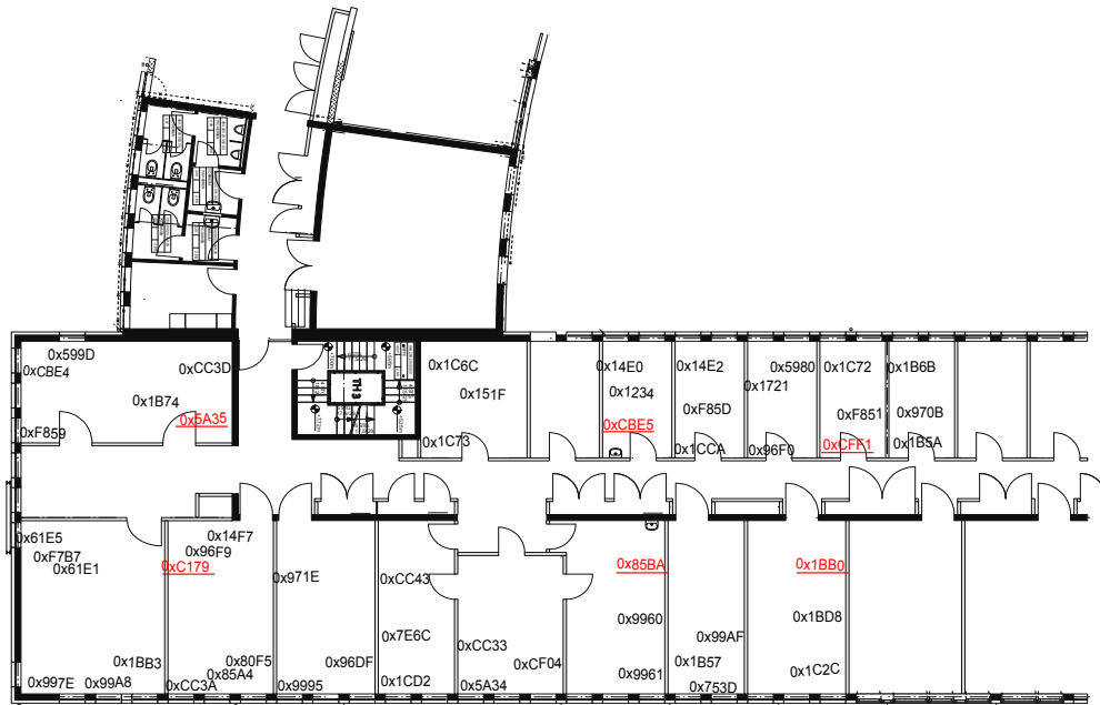
Abbildung 9.3: Topologie des WISEBED Testbeds am Institut für Telematik der Universität zu Lübeck (dargestellt sind die IDs der iSense Knoten des jeweiligen Clusters).
