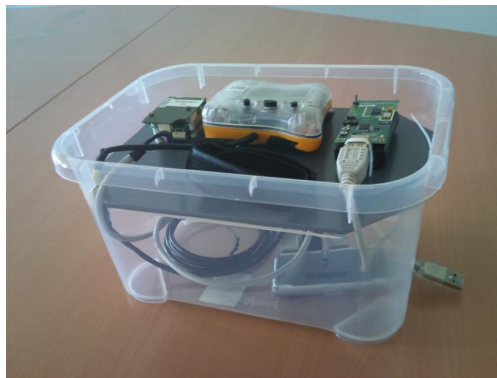
Abbildung 9.2: Cluster bestehend aus einem iSense, TelosB und Pacemate Knoten.
